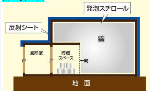
雪むろ内部の断熱構造
