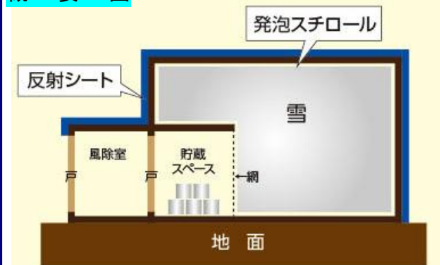
雪むろ内部の断熱構造
