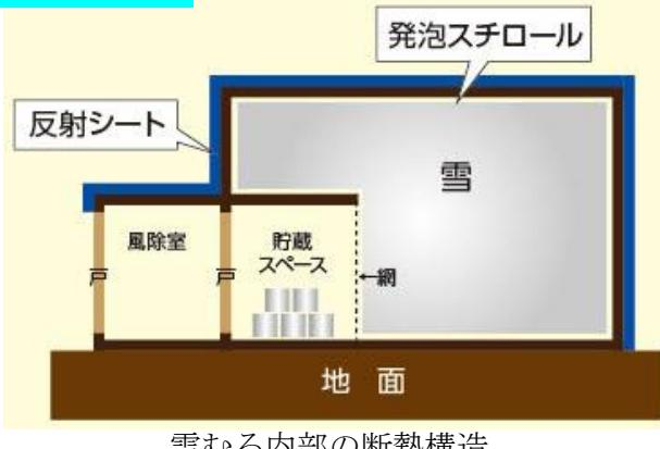
雪むろ内部の断熱構造
