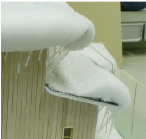
2階の屋根雪は、1階の屋根に落ちるので、2階の窓を塞いでしまうことや1階の屋根に掛かる衝撃に対して注意を要する。
